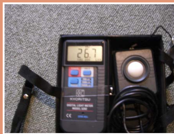
照度計による測定
